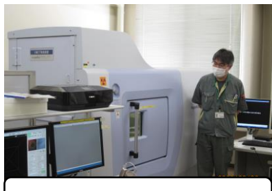
X線CT検査で製品故障箇所を特定
